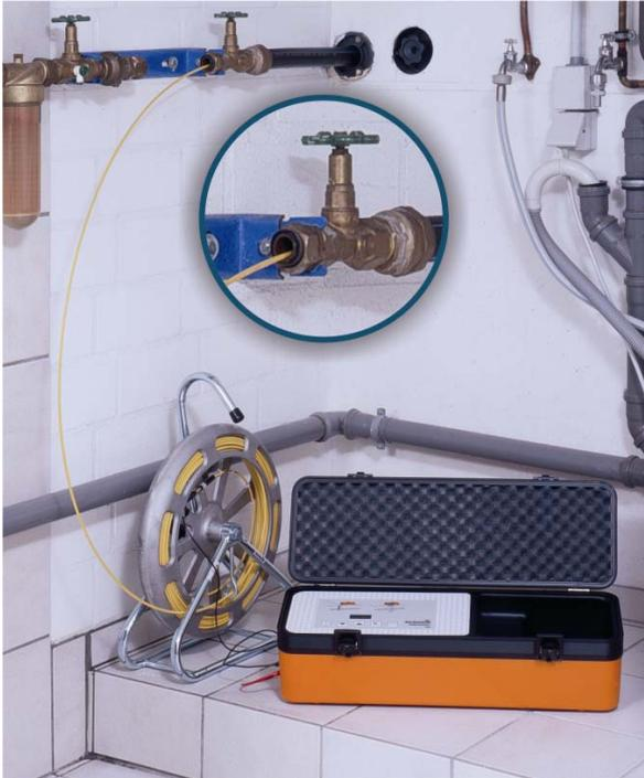
Glass-fibre rod GSK / sluice / generator G1
